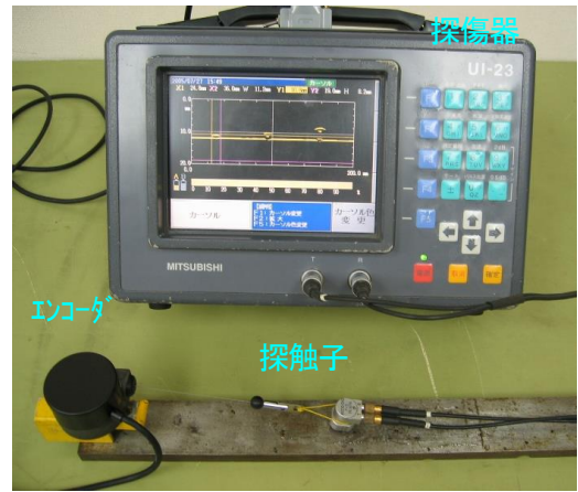
超音波半自動板厚線測定装置
