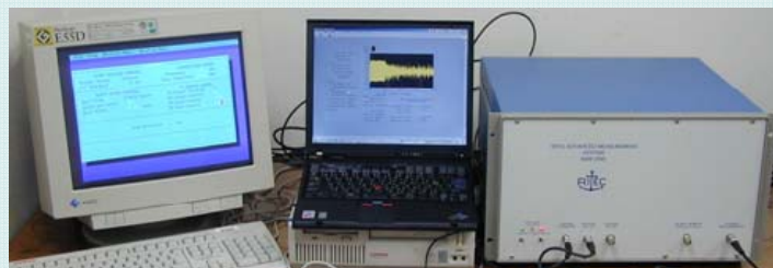
測定状況(防食テープ上から配管の肉厚測定)と装置構成
