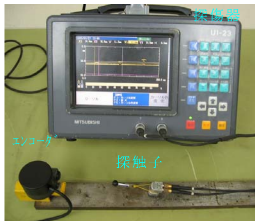
超音波半自動板厚線測定装置
