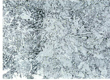
溶接熱影響部
