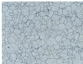
オーステナイト系ステンレス鋼の 金属組織(鋭敏化組織)
