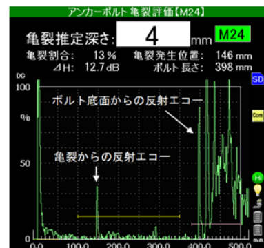
図4 亀裂点検結果例
