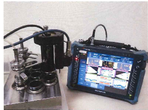
図2 探傷器・ジグ外観
