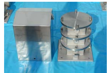
(a) 制振装置の全体写真
