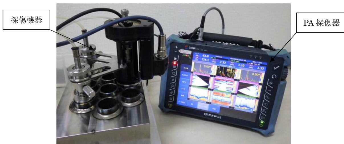
図1 フェーズドアレイ超音波探傷検査システムの構成
