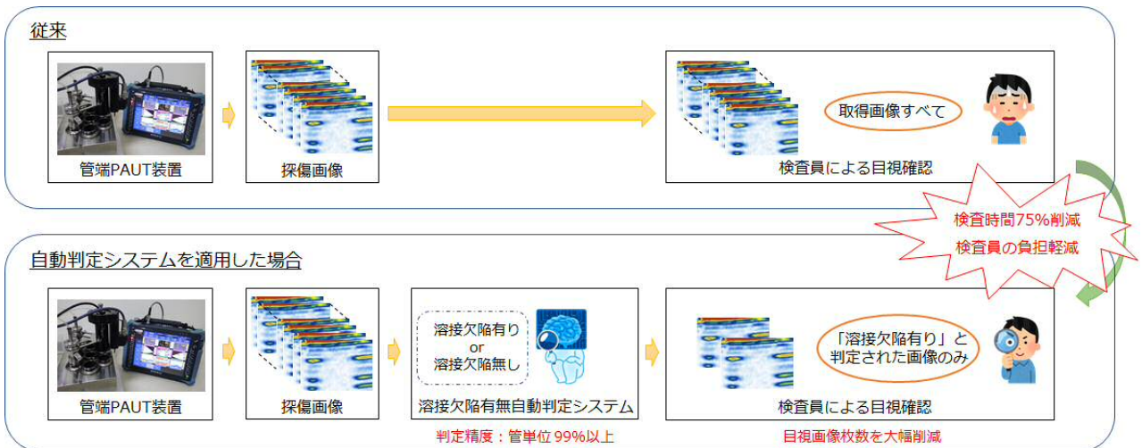
図 3 AI を用いた欠陥有無自動判定システムの導入による効果例
